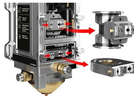
Для замены фокусирующей линзы или защитного стекла достаточно извлечь картриджи из оптической головки и поменять их на запасные.
