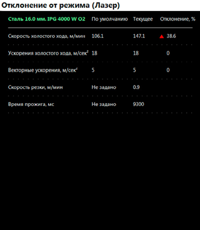
Экран «Отклонение от режимов» отображает рекомендуемые и текущие настройки параметров резки (для материала и станка), а также отклонение текущих настроек от рекомендованных в процентном соотношении.
