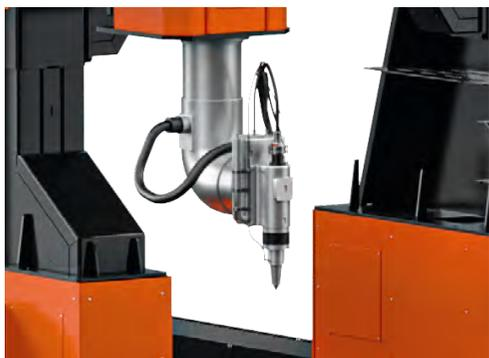
Установка лазерной режущей головки на место фрезерной превращает платформу в крупноформатный пятиосевой раскройный комплекс. Такое устройство способно эффективно обрабатывать не только плоские заготовки, но и трёхмерные объекты сложных форм — рамы, каркасы, штампованные детали и прочие.
