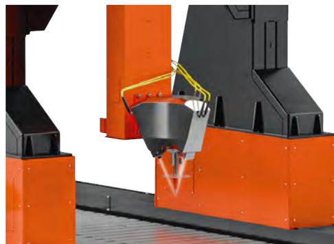
Нанесение слоёв металла, расплавляемого посредством лазера. К точке плавления металл подаётся в виде проволоки, а при остывании образует металлический валик с заранее определёнными параметрами. Такие валики, укладываясь друг на друга в соответствии с движением печатающей головки, формируют объёмное изделие. Технология допускает использование широкого спектра конструкционных сталей и сплавов.
