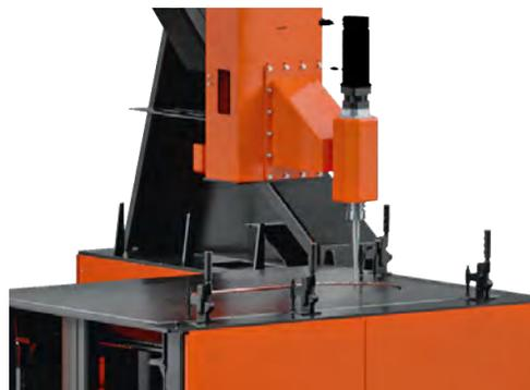
Инкрементальная формовка представляет собой процесс деформации листового металла пуансоном со сферическим торцом,двигающимся по заданной траектории. Замена печатающей головки таким пуансоном позволяет изготавливать штучные изделия сложной геометрии из стали толщиной до 3 мм.
